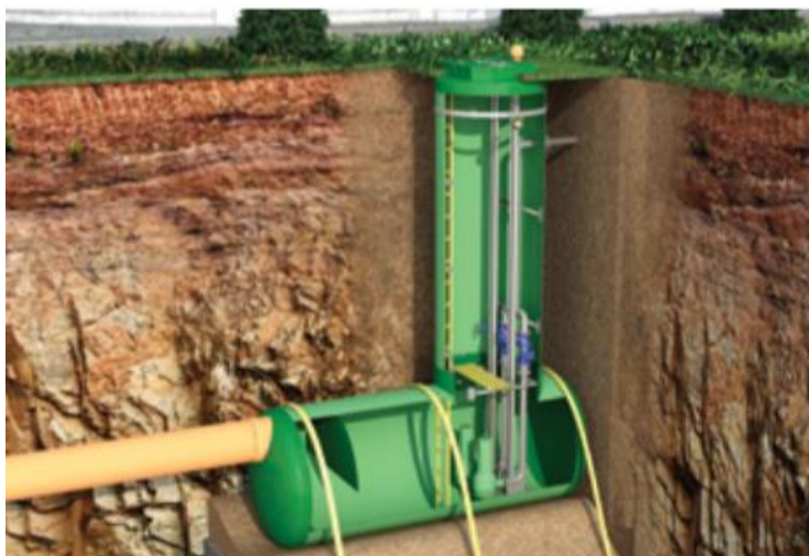
Рис 1. Комплектная насосная станция горизонтального исполнения «FloTenk-KNS-G», общий вид.
